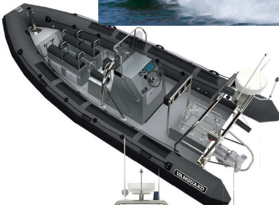
Embarcación TX-760 equipada con propulsión por turbina Hamilton.
