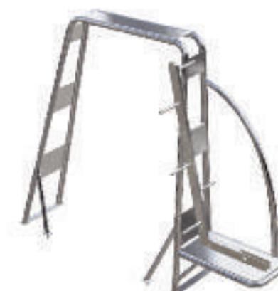
Arco de luces diving con escalera
